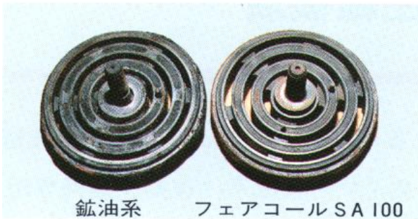
鉱油系 フェアコール SA 100 低压側吐出弁
